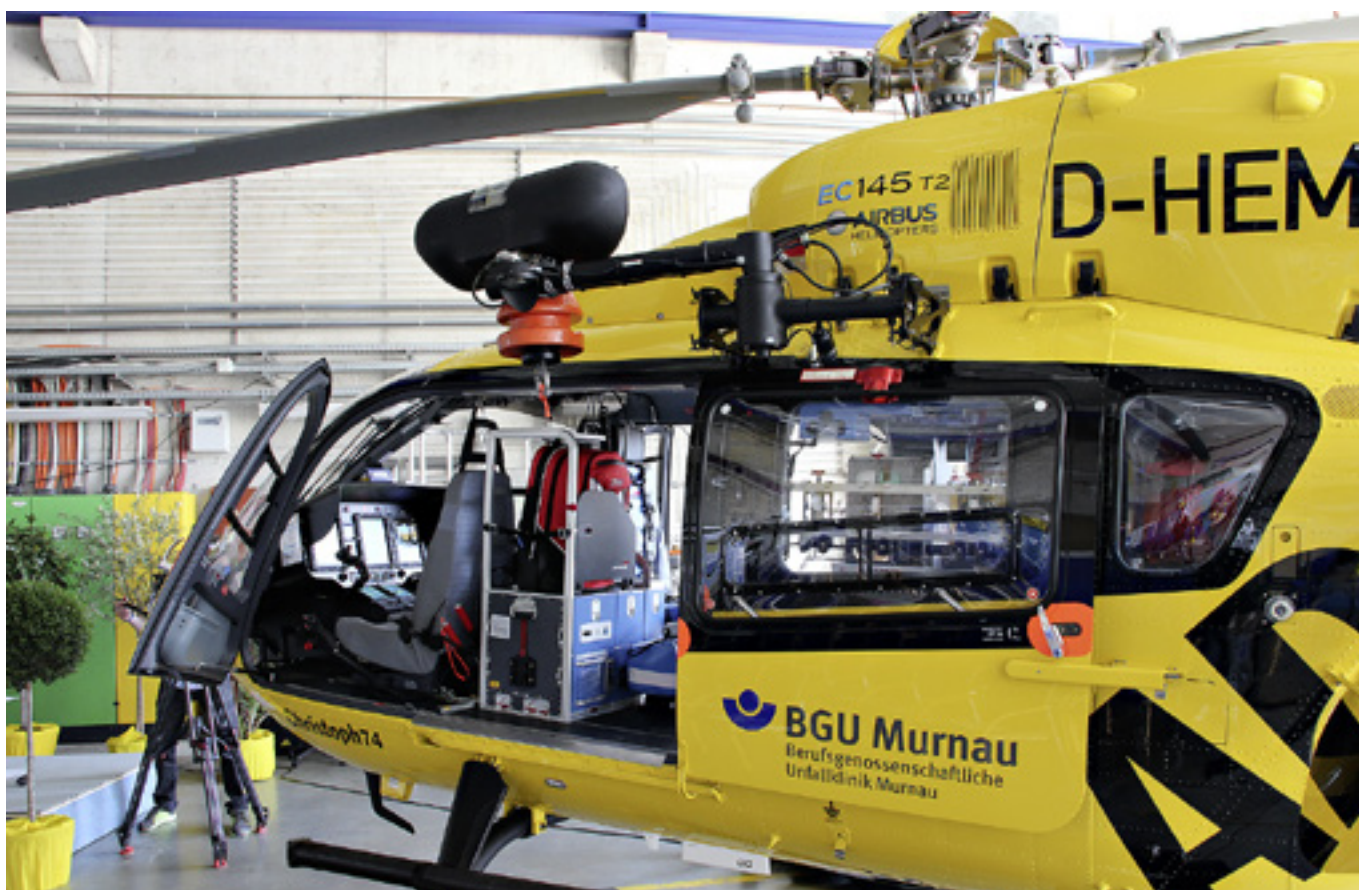
Rettungswinde an der H145T2, auf linker Maschinenseite montiert.
